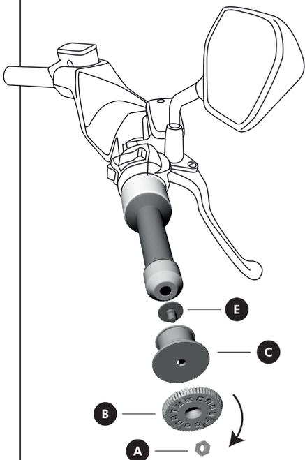
En utilisant le boulon **E** à l'intérieur de l'adaptateur en caoutchouc **C** pour encastrer sur sustabilisateur. Puis vissez la bague de fixation **B** avec l'écrou coincé **A**.
