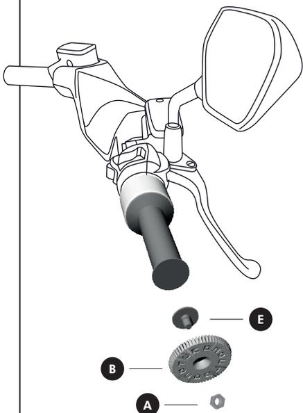
**I** Utilizzando il fissaggio della sola stecca metallica con velcro, mentre per chiudere il foro sulla manopola utilizzare il bullone **E**, avvitandolo nella ghiera **B** con incastrato il dado **A**
