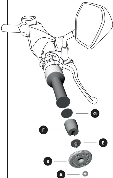
En utilisant la fausse stabilisateur **F** à fixer sur le bord de la manchon à l'aide de biadhésif **G** (nettoyez bien la surface avec de l'alcool). Ensuite, insérez le boulon **E**, et vissez la bague de fixation **B** avec l'écrou inséré. **A**
