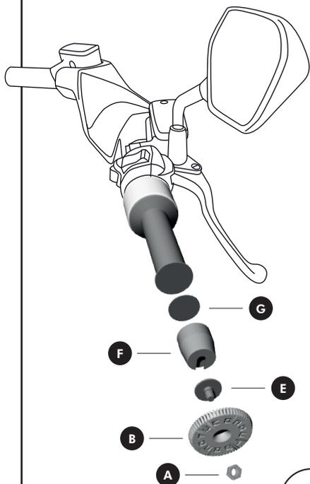
**I** Utilizzando il finto bilanciere **F** da fissare sul bordo della manopola tramite il biadesivo **G** (pulire bene la superficie con alcool). Quindi incastrare i il bullone **E** e avvitare la ghiera **B** con incastrato il dado **A**
